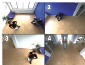
Cztery wirtualne kamery PTZ w porównaniu z jedną kamerą hemisferyczną 360°
