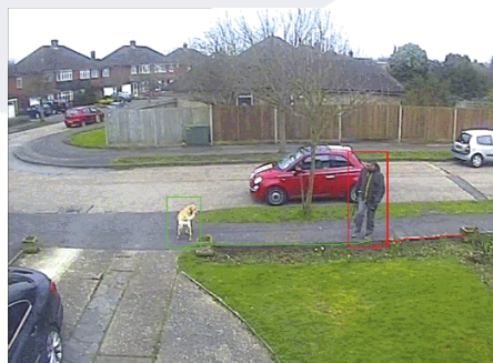
Dzięki parametryzacji liczba fałszywych alarmów jest zminimalizowana
